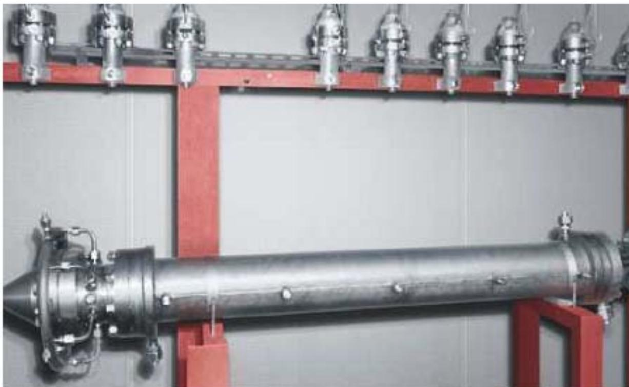
Рис. 2. Реактор гомогенного окисления
